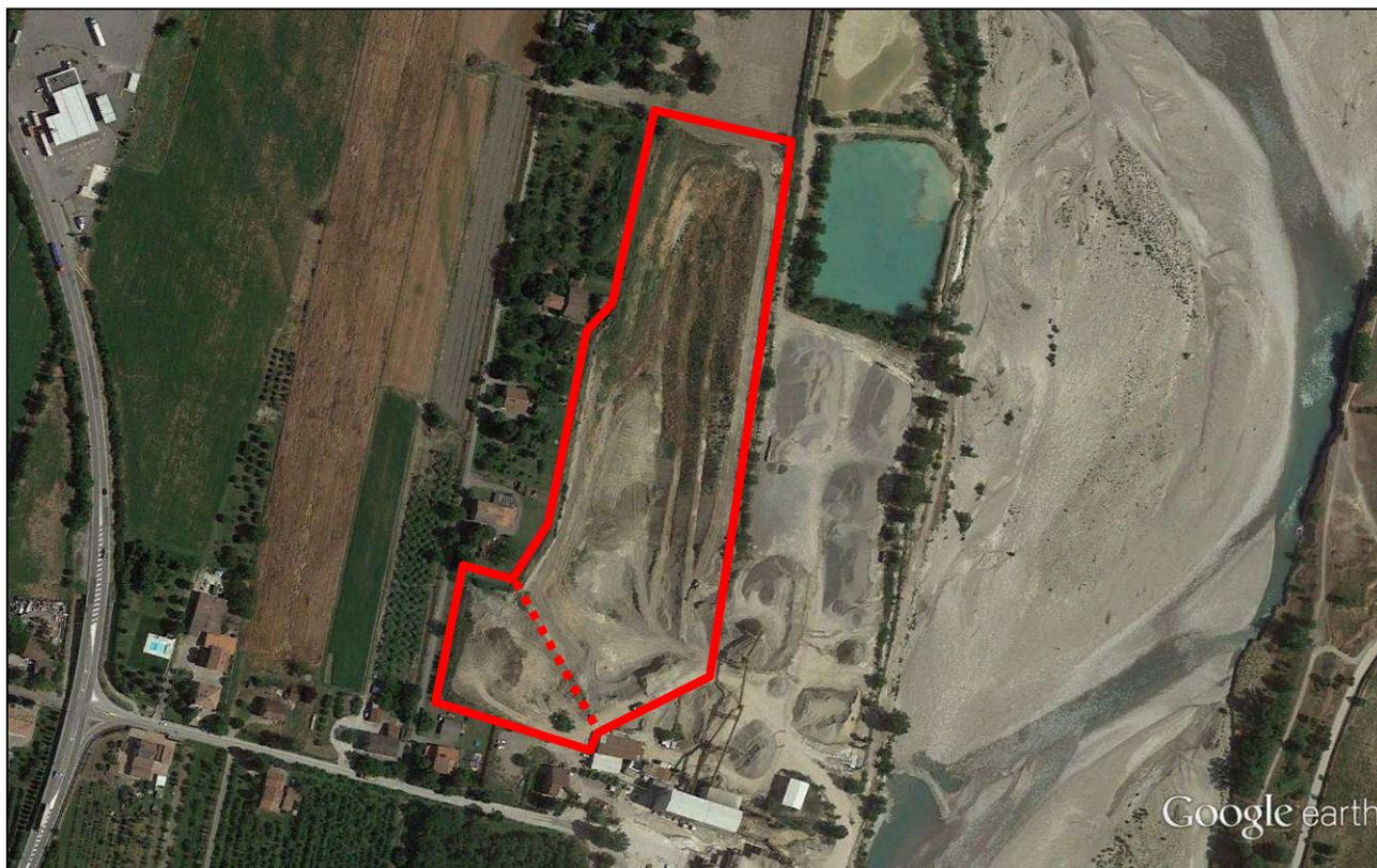
*Figura 3: Area di cava "La Vigna" su ortofoto Google 2014 – fase precedente all'avvio dell'invaso con limi di frantoio. Si notino l'avvio delle procedure di chiusura dell'attività estrattiva con la costruzione della barriera geologica di confinamento sul fondo cava.*
