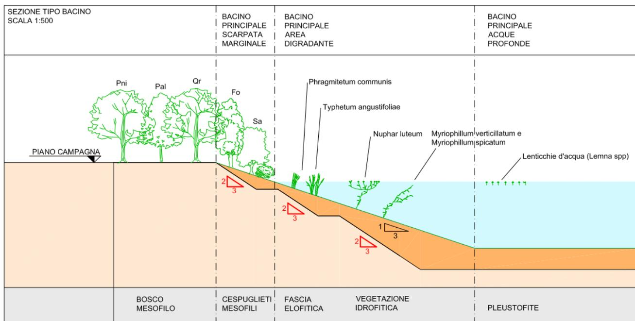
Partendo dai citati riferimenti, si riporta di seguito la geometria delle scarpate di ripristino e del confinamento su fondo e pareti scavo previste ai fini del rilascio del sito ad invaso impermeabilizzato:
