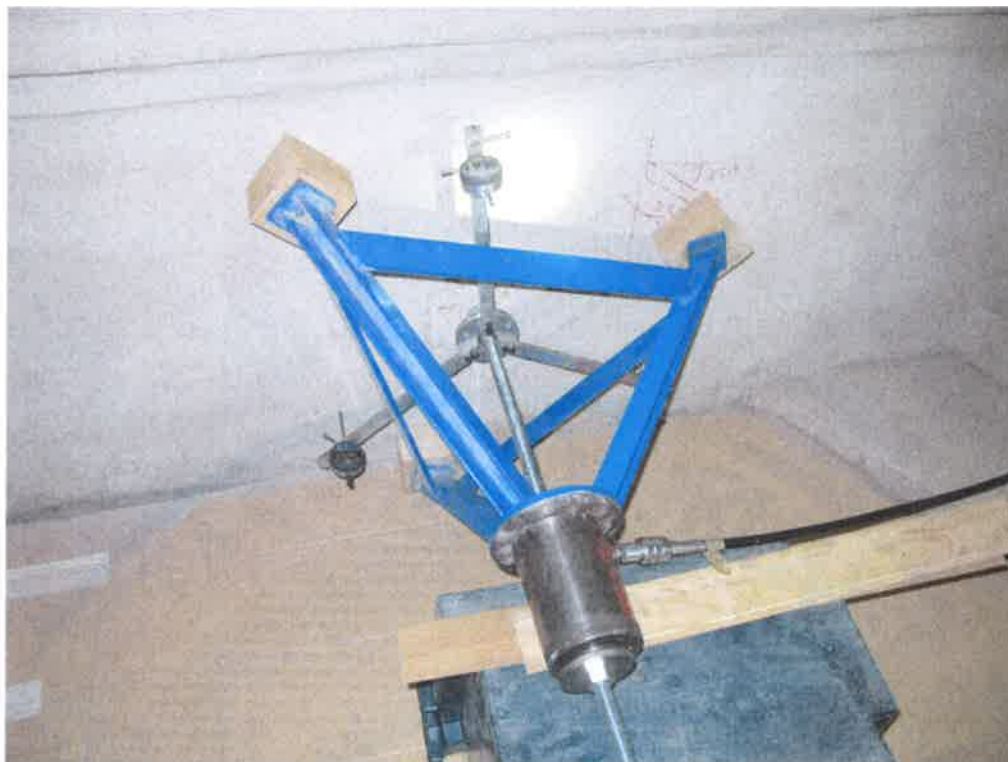
Fotografia 1 – Prova di estrazione
