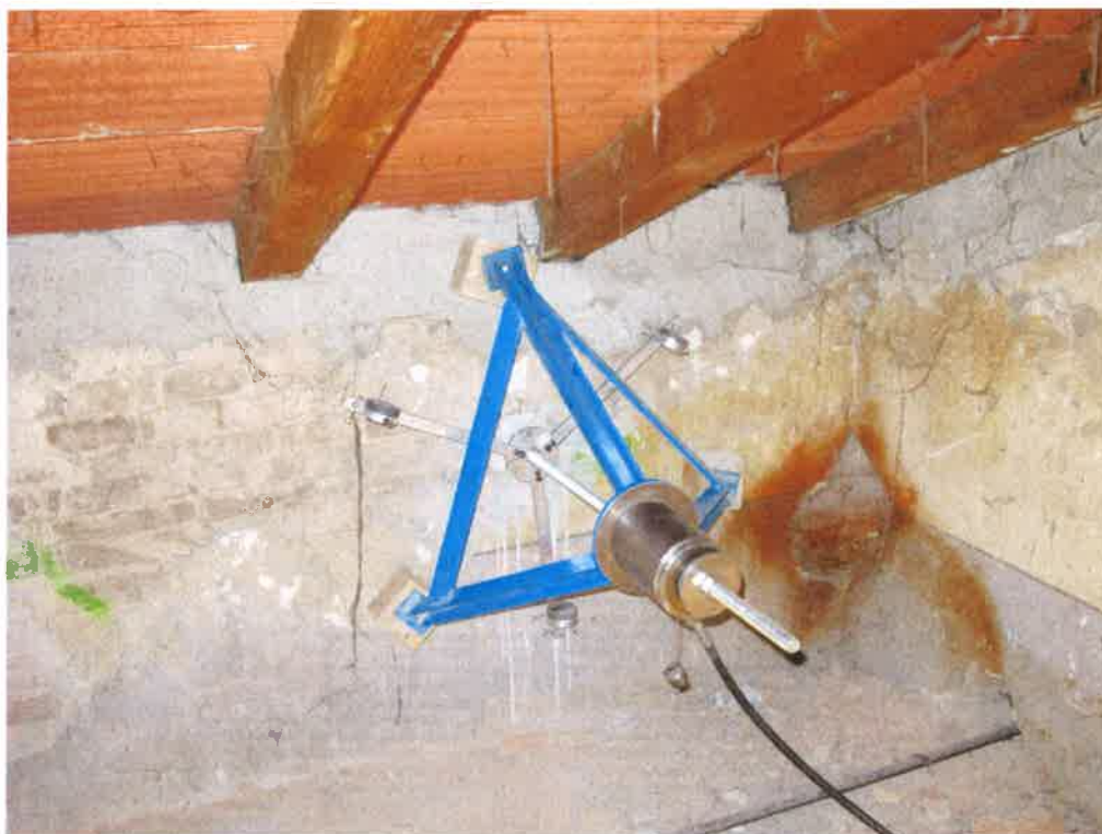
Fotografia 1 – Prova di estrazione
