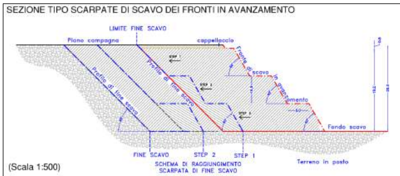
Figura 9 – Sezione tipo di scavo dei fronti in avanzamento e di fine scavo
