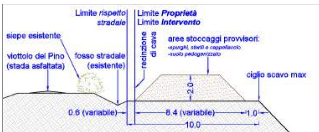
Figura 8 – Accumuli di cappellaccio-spurghi e/o suolo pedogenizzato lungo il lato d'intervento sud
