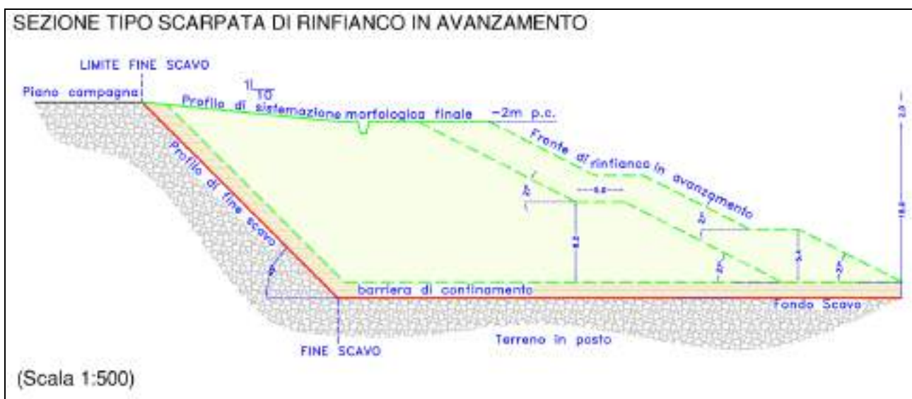
Figura 10 – sezione tipo della scarpata di rinfianco in avanzamento
