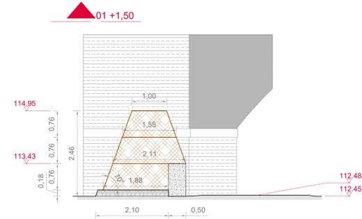
A - Sezioni rilevato con terre armate
